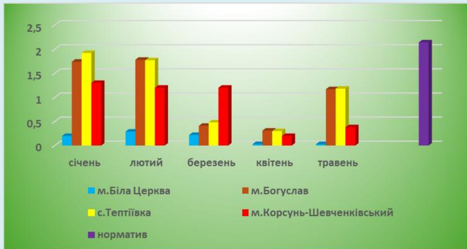
Рис.2 Вміст фосфатів у створах питних водозаборів в басейні Росі протягом січня – травня 2026 р.
