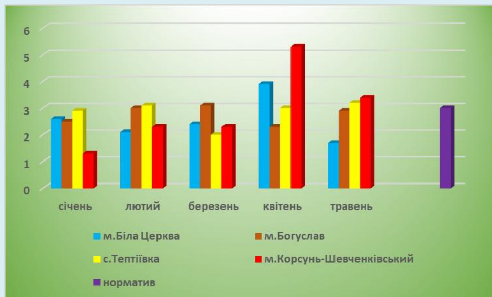
Рис.1 Вміст БСК 5 у створах питних водозаборів в басейні Росі протягом січня – травня 2026 р.
